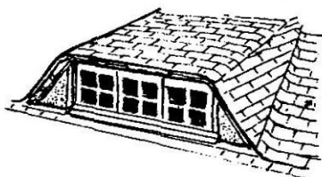
lucarne en trapèze (couv. bardeaux d'asphalte)
