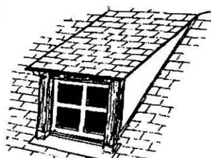
lucarne rampante ou en "chien couché"
